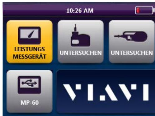
Abb. 4: OLP-82P-Startbildschirm mit über USB angeschlossener P5000i-Sonde und USB-OLM der MP-Serie
