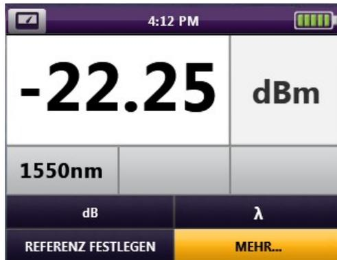
Abb. 21: Pegelmesser Steuerelemente
